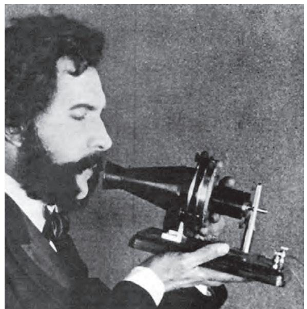
Figura 1.2 • Primo apparecchio telefonico utilizzato dall'inventore Bell.
