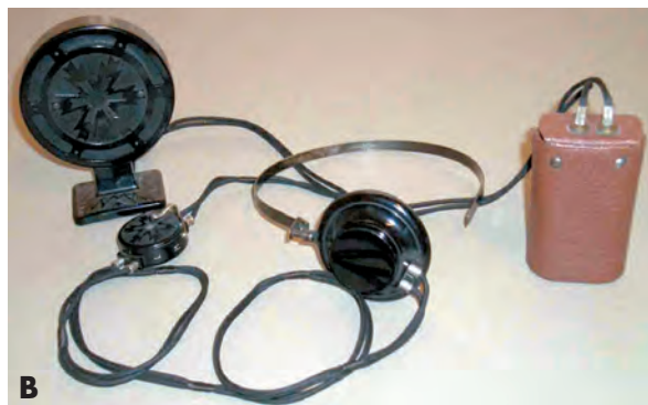
Figura 1.3 • A) Pubblicità italiana del primo apparecchio acustico denominato "Telefono portatile e tascabile". B) Apparecchio acustico con microfono a carbone.
